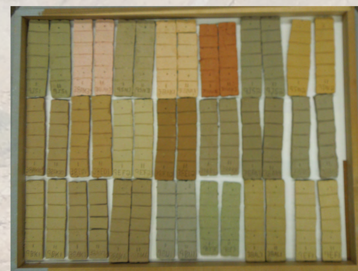
Figure 2. Molded clay briquettes subjected to compositional analyses. Figura 2. Muestras de arcilla sometidas al análisis petrográfico y de activación neutrónica.
